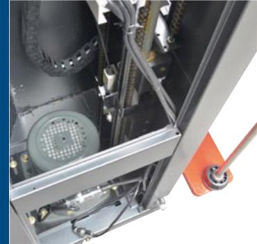
Der **SP-FG-2000BW** ist ein Palettenwickler für automatisches Einstretchen von Paletten mit Vorreckanlage. Der Drehteller hat einen Durchmesser von 1500 mm und ist frequenzgesteuert. Durch die Aussparung im Drehteller kann die Maschine einfach durch Flurfördergeräte und Gabelhubwagen bestückt werden.
