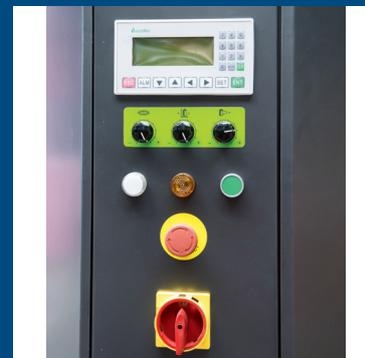
Der **SP-FG-2000B** ist ein Palettenwickler für automatisches Einstretchen von Paletten mit Vorreckanlage. Sie ist besonders für das Einstretchen von leichteren Paletten geeignet. Der Drehteller hat einen Durchmesser von 1500 mm und ist frequenzgesteuert. Verschiedene Turmhöhen oder Tellerdurchmesser sind auf Wunsch machbar.
