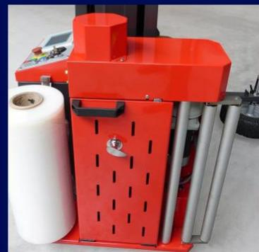
*Der Stretchroboter SP-CTP 600B ist ein unabhängiges Modell für automatisches Einstretchen von Paletten. Die Maschine verarbeitet Powerfolie für Vorreckanlagen mit einer Vorreckung von 250 %. Die Mindestgröße für Paletten beträgt 600 x 600 mm. Der Folienschlitten ist für das automatische Abtasten der Palettenhöhe mit einer Fozelle ausgerüstet.*
